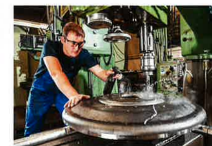
La plus grande précision est requise. On voit, sur la photo de droite, le tournage des trous de moyeu et des cercles primitifs du disque de roue sur le tour vertical à carrousel.
