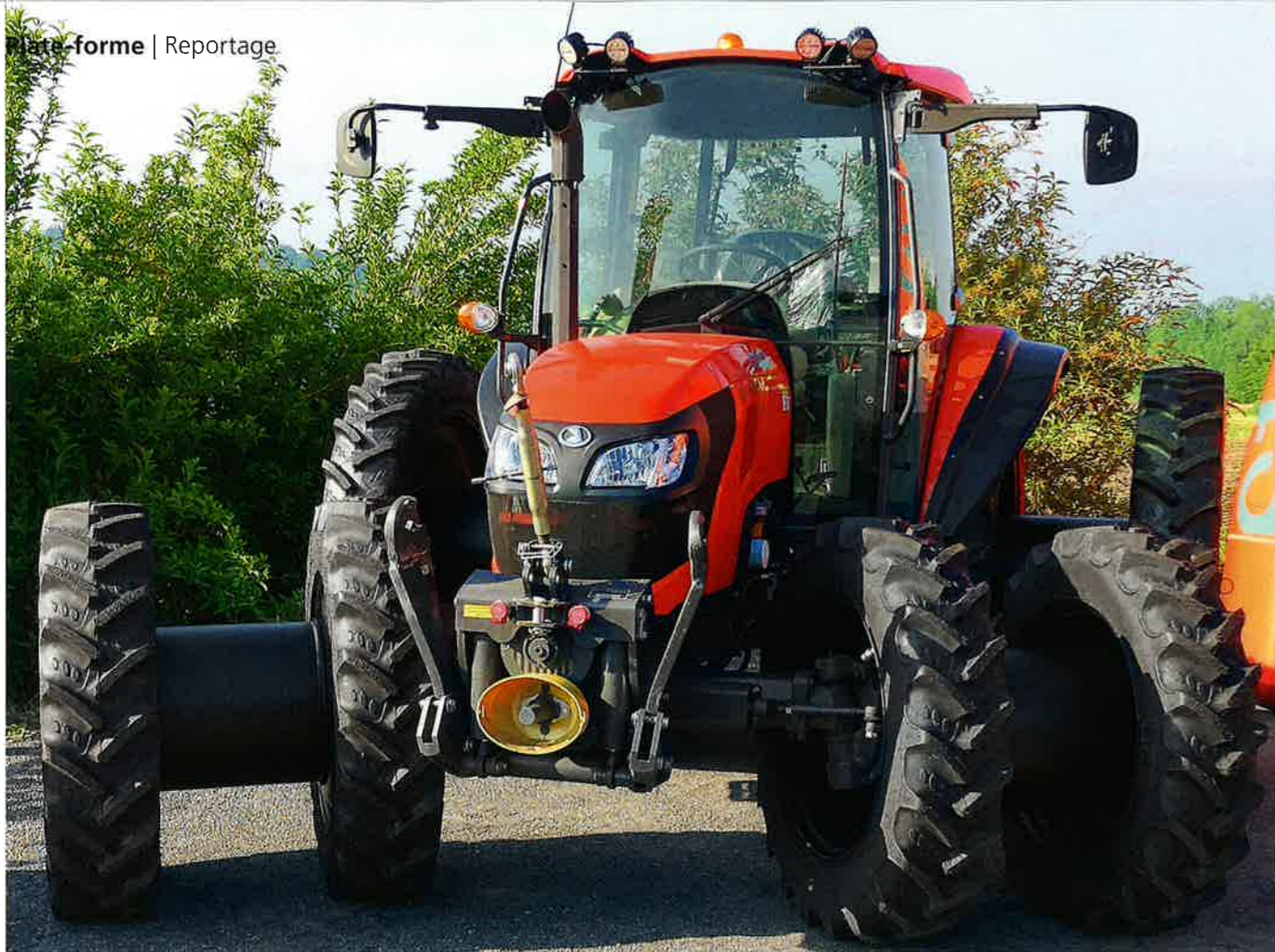
Grâce à la liaison par dents, le montage de roues jumelées est possible pour toute taille de roues et en toute position. Pour les roues de culture, il existe différents types d'entretoises pour adapter les écartements. Photos: Agro-Räder et Dominik Senn
