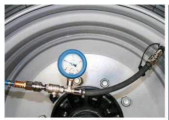
dégonflage instantané au champ pour une protection maximale du sol de 1,4 bar à 0,8 bar
